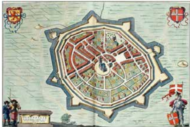
Afbeelding 3.1 Historische kaart met hierop zichtbaar de structuur van de 2 e 'omwalling' (stadsmuur met gracht en de buitenvesting). (Bron: Plattegrond van de vesting Oldenzaal door Blaeu met situatie in 1626, uitgave 1649)
