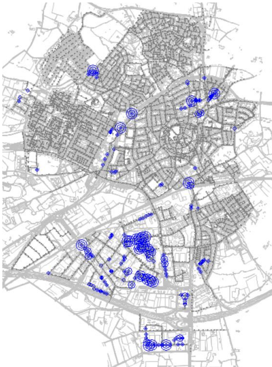
Figuur 3.4 Putten waar in het 1D-model het water bij Bui08 niet afdoende kan worden verwerkt, waardoor water op straat voorkomt (situatie 2015)
